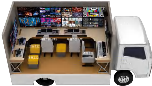
NDI转播车长宽高: 5995*2440*3185 mm 注: 本图仅为结构示意图, 具体以实物为准。
