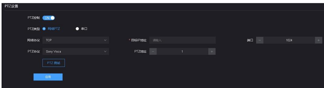
图 53 设置-PTZ 网络 PTZ 控制参数设置
