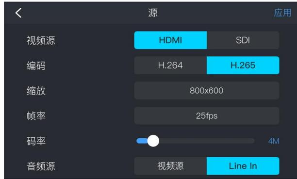
图 6 LCD 屏幕编码源配置界面
