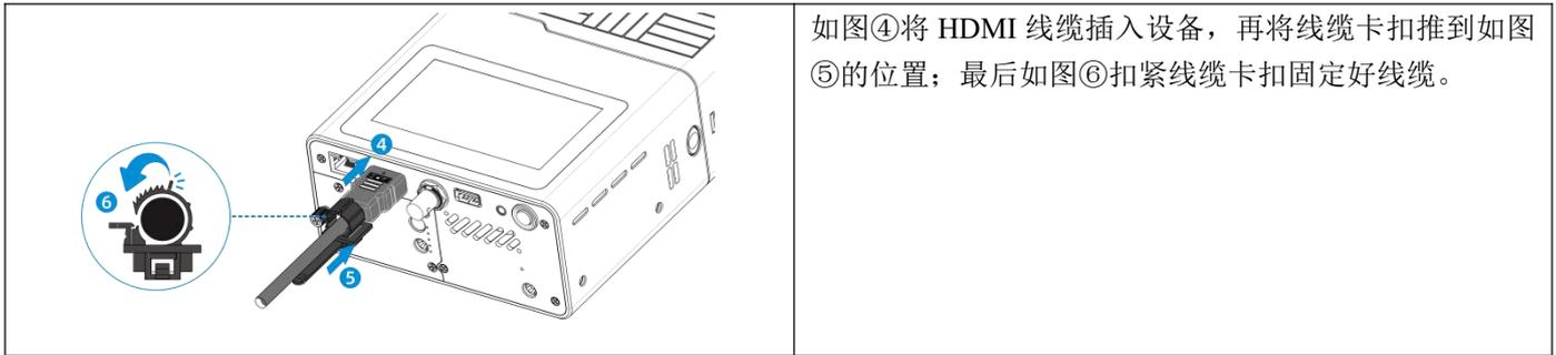
如图④将 HDMI 线缆插入设备，再将线缆卡扣推到如图⑤的位置；最后如图⑥扣紧线缆卡扣固定好线缆。
