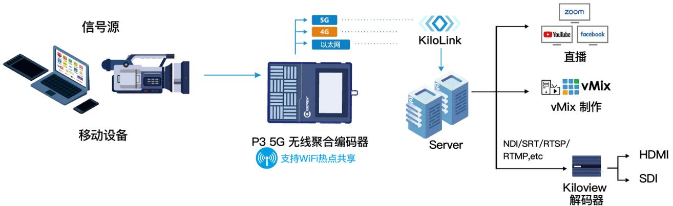
为实现 P3 的聚合传输，需要有一台 KiloLink Server Pro 服务器，并在服务端配置 P3 的设备注册信息（KiloLink Server Pro 服务器的配置与详细使用方法请参考 KiloLink Server Pro 的操作手册）；在 P3 设备端进行聚合传输之前，也需在设备端配置 P3 设备与 KiloLink Server Pro 连接对应的参数。
