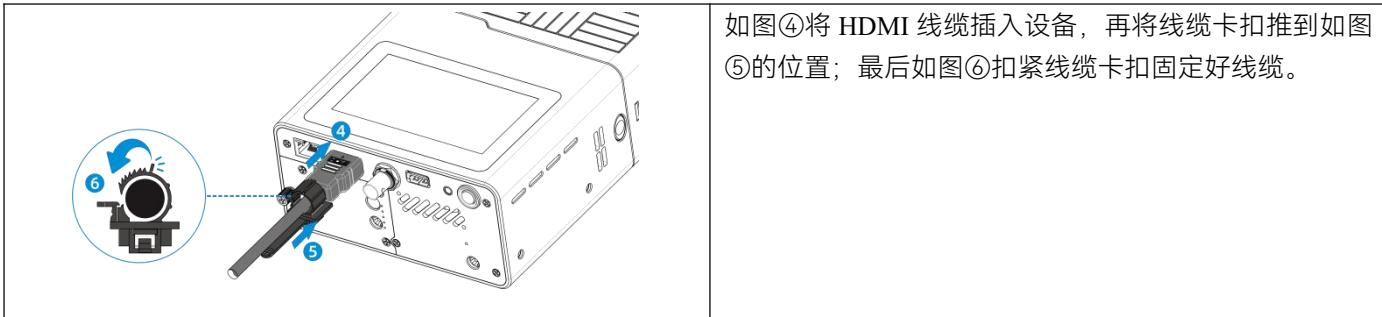
如果需要取出已绑定的 HDMI 线缆，可通过按下图①②处卡扣解锁，然后取出 HDMI 线缆。如下所示：
