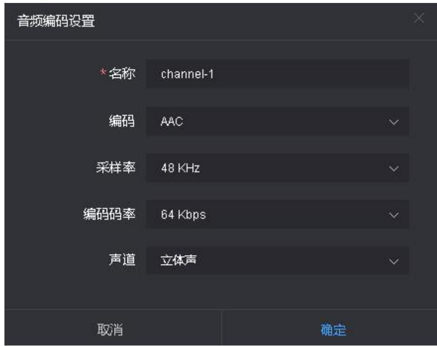
图 39 音频编码参数配置选项
