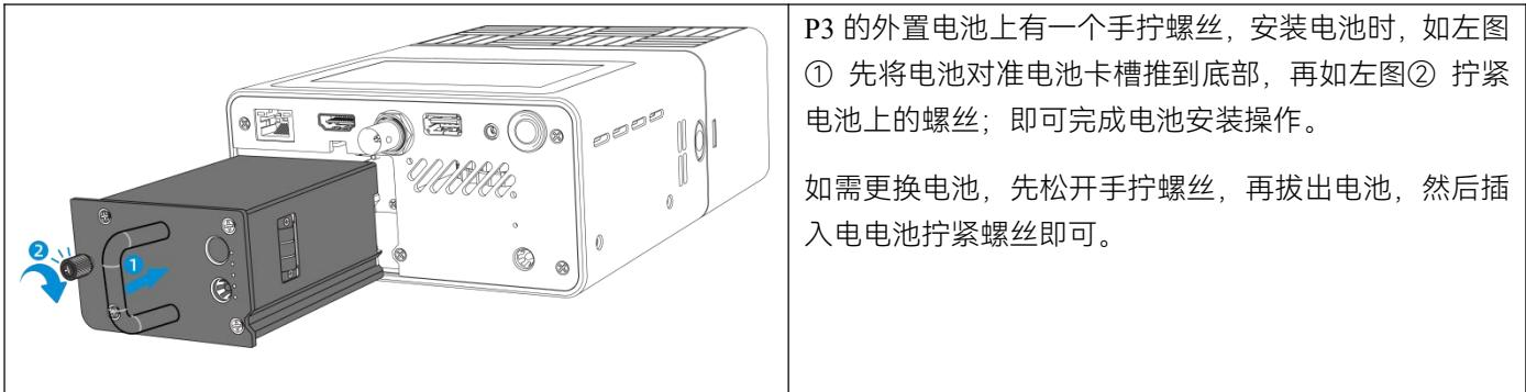
P3 主机除了外置电池以外，在设备内部也内置了电池。内置电池可以在 P3 更换外置电池的过程中，为设备供电；使您的 P3 在工作时不受更换电池影响。
