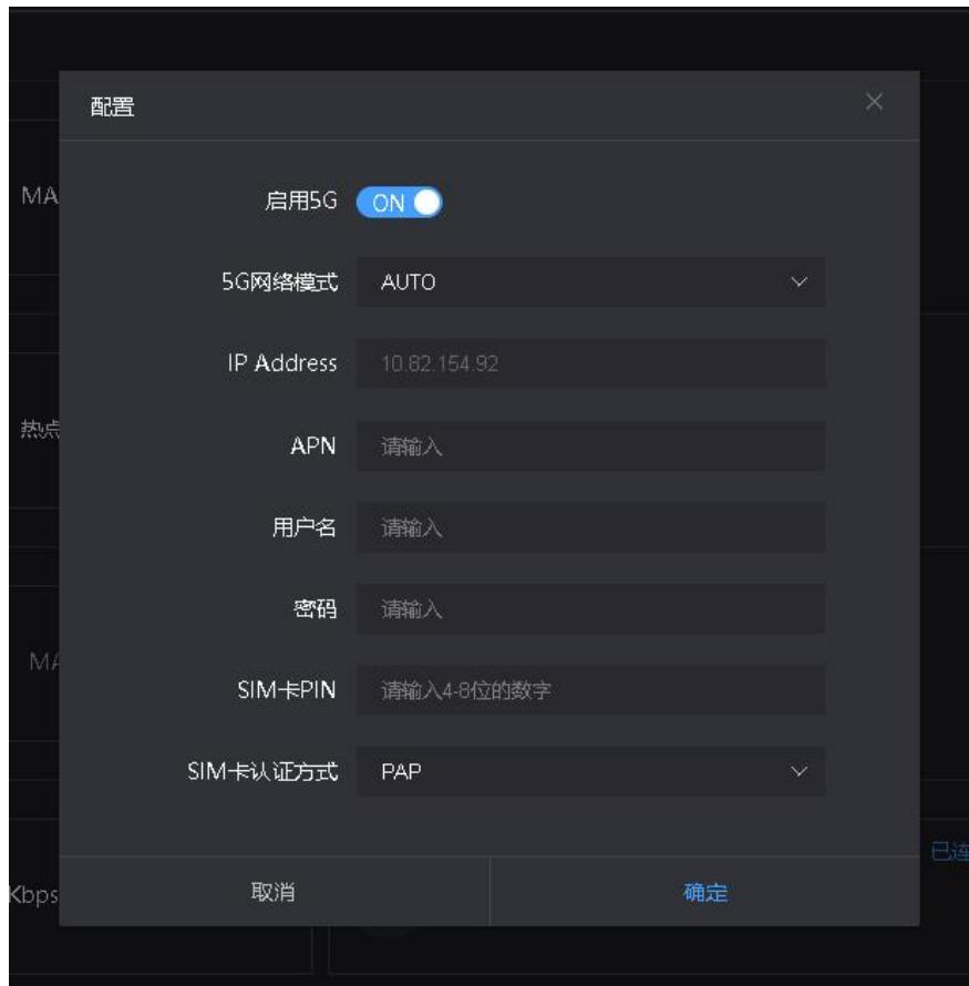
图 24 4G/5G 模块参数配置
