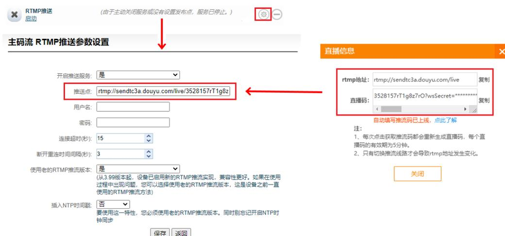
**注：部分平台RTMP推流地址和直播码是分开的，在填写时，需要使用符号“/”在RTMP地址后面加上直播码。格式为：rtmp地址/直播码。**
