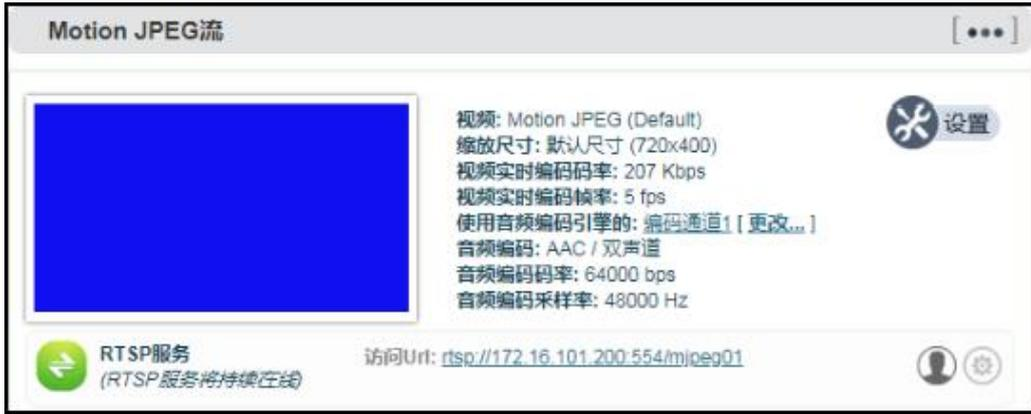
**注：如果设备输入端已经连接视频源，但仍然显示蓝屏或者异常，请检查输入的视频格式或者线缆等。**
