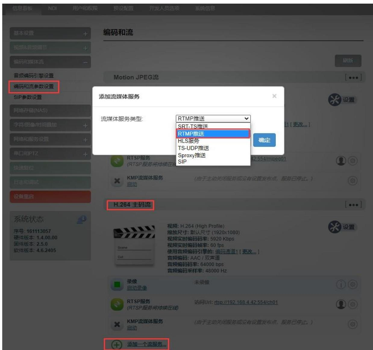
以斗鱼平台直播为例,首先在直播平台获取 RTMP 推流地址。进入斗鱼平台的直播设置,开启直播间,您可以看到推流地址,将这个地址填入到 RTMP 推送点的 URL 地址中,并开启流推送服务。这样你就完成了直播设置,在斗鱼直播间看到摄像机的画面。
