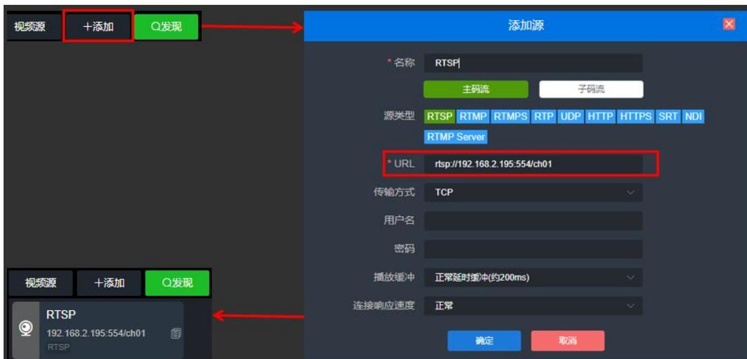
所有添加的源都展示在视频源栏，不进行操作解码时，状态为灰色不在线。如需预览或解码输出，需手动拖至上方预览或输出区域解码。视频源显示为绿色“显示/推流”，则视频源处于解码或推流状态。
