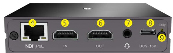
④ 1000M以太网口(支持POE) ⑤ HDMI输入 ⑥ HDMI输出
