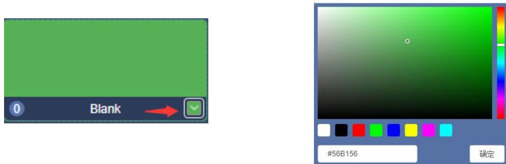
点击右侧图标 ，进入平滑切换设置。当视频较大或者传输较慢时，设置较长的平滑时间可以保证切换画面达到更好的平滑切换效果，否则当切换后画面还未输出时会显示设置的 Blank 画面。
