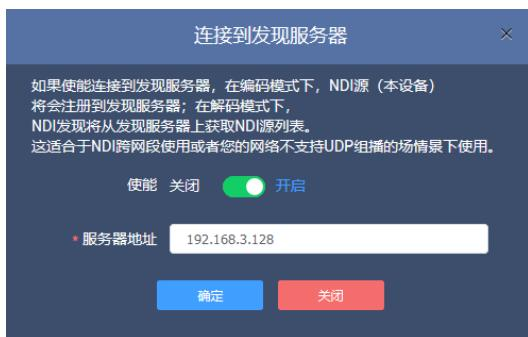
**⚠ 注意：** 开启此功能后，mDNS 自动发现功能无效。编码器输出视频流只能发送给指定的服务器，接收端必须注册到同一个发现服务器才能拉取 NDI 流。
