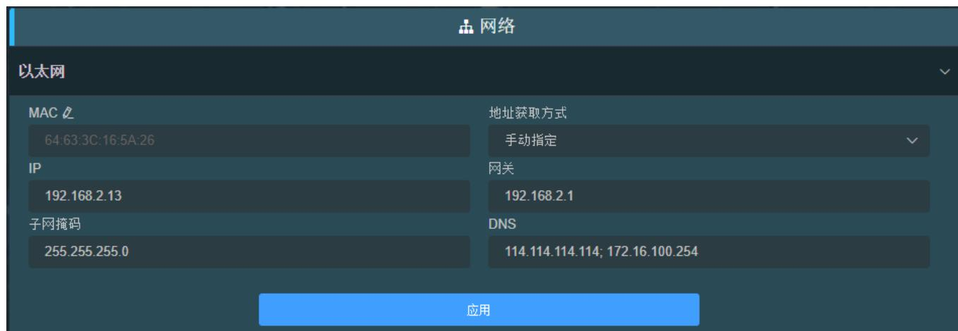
以太网有两种地址获取方式，一种是 DHCP 自动获取 IP，另一种是手动指定 IP。使用 DHCP 自动获取 IP 的方式，就首先要保证路由器或交换机开启了 DHCP 服务，这种方式比较简单方便，但是 DHCP 的方式得到的是一个会不断变化的 IP，而且也无法知道设备得到的 IP 地址是多少。手动指定的方式，是需要自己输入一个固定的 IP 给设备，而且这个 IP 地址如果设备不恢复出厂设置的话，是固定不会改变的，这种方式就比较稳定。所以说两种方式各有好处，可以根据实际需求来进行选择。
