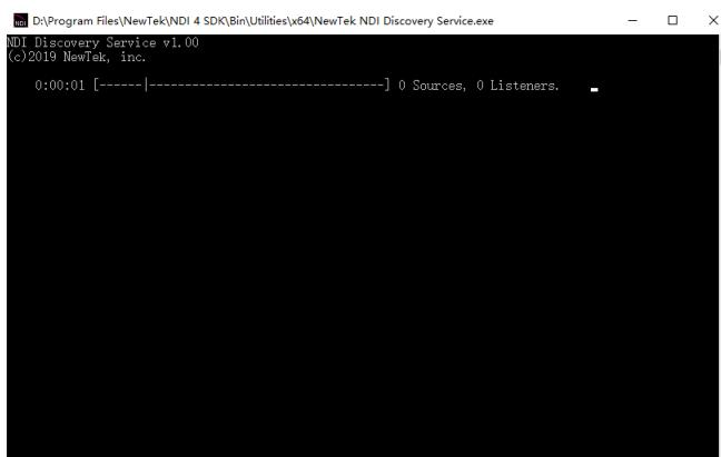
NDI 编码器在发现服务器中配置接收端 IP 地址，NDI 将注册到服务器。建议接收端地址配置为静态 IP 地址，以防止重新分配 IP 导致 NDI 连接丢失。
