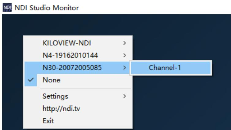
打开 Monitor 工具播放 NDI 的视频后，点击播放器右下角的齿轮状按钮 ，可以直接打开 NDI 设备的 WEB 管理页面，方便直接对 NDI 设备进行管理。
