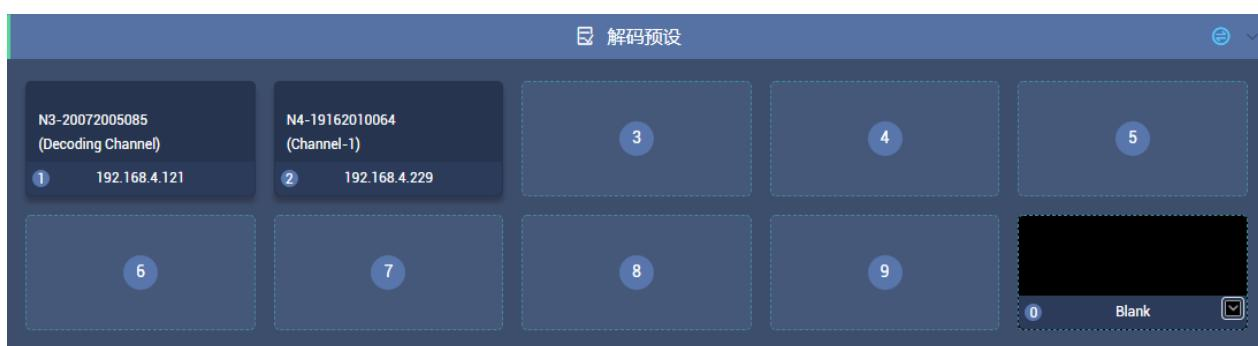
解码预设栏保留一个空白输出框，当切换至无解码输出的视频源时，设备输出此框设置的色彩。也可以用于测试输出，选择不同的色彩区域，可输出不同的色彩到监视器。
