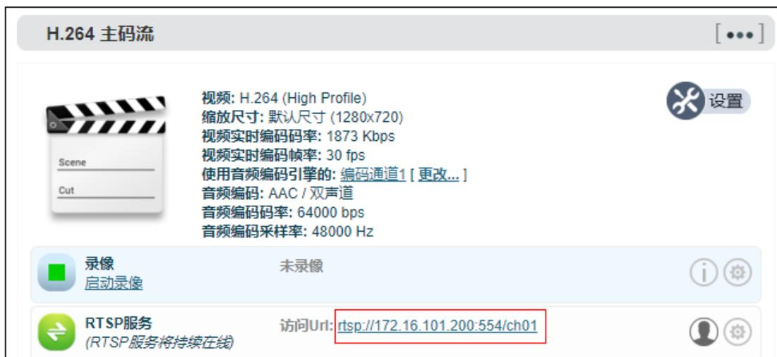
同一局域网电脑上可通过 VLC 拉取 RTSP 流，测试编码是否正常和查看参数信息等。安装打开 VLC 后，选择“媒体”，然后“打开网络串流”，会进入一个输入网络 URL 的界面，将编码器的 RTSP 服务的 URL 地址填进去，就可以播放了。
