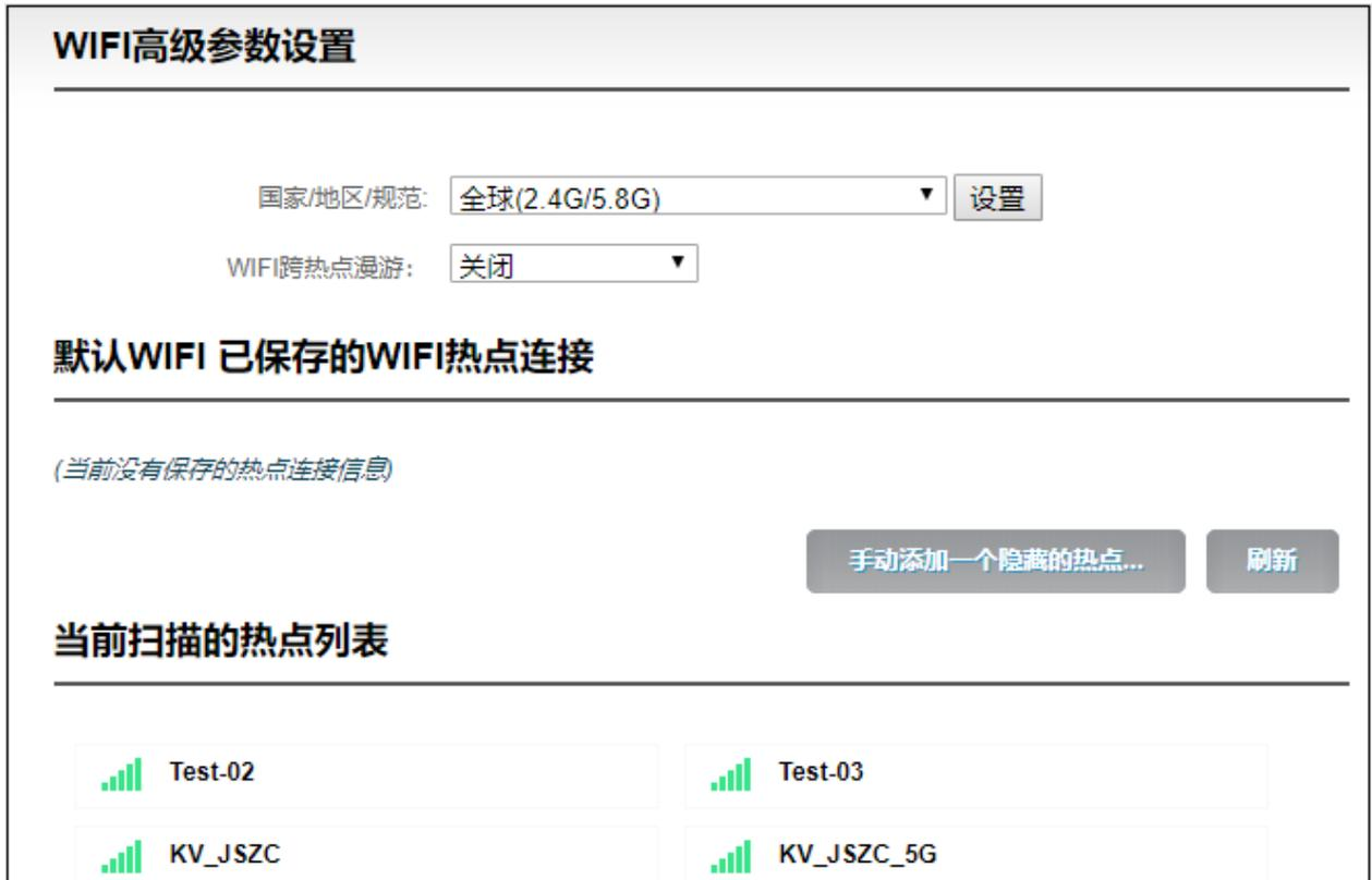
**⚠ 注意：**为减少无线网络干扰，获取良好的视频播放体验，建议您将 WIFI 路由器和编码器尽量置于可视范围内，编码器连接 WIFI 的 5G 频段，将路由器的 WIFI 设置为一个相对干净的信道。拉流过程中，根据无线网络情况，必要时可适当降低编码码率，以保证视频的流畅性。
