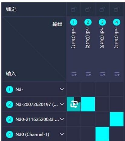
在“IO 面板”仅展示方式不同，所有操作的效果和“交叉点”完全一样。点击 OUT1 输出通道，此时可以看到第一个 NDI 源显示青色，表示该 NDI 视频源从 OUT1 输出，点击第二个视频源，当变成青色高亮时，将无缝切换到第二个视频源从 OUT1 输出。
